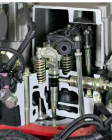
Оптимално изгаряне, благодарение на четирите клапана на цилиндър и 6-точковите инжекционни дюзи
