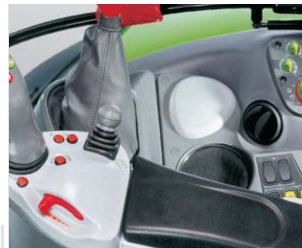
Powershift степените може да се превключват също и от PowerComS операционния лост
