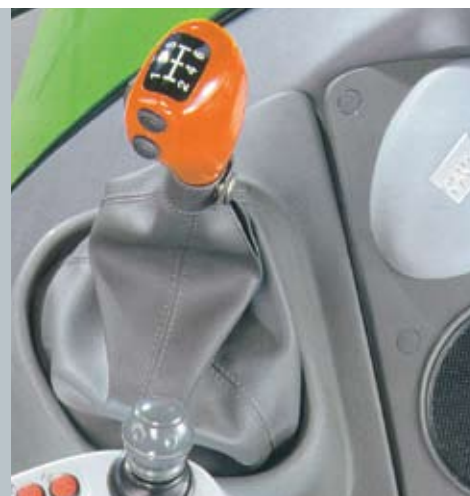
6-скоростната главна трансмисия и 4-степенния Powershift може удобно да се управляват от скоростния лост.
