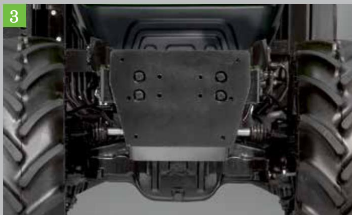
Предна монтажна плоча за бързо и здраво закрепване на специални устройства.
