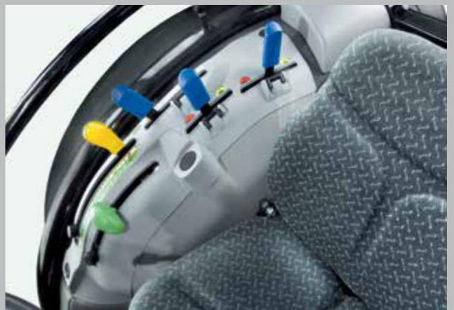
Механични, функционални и ергономични лостове за контрол на задния навес.
