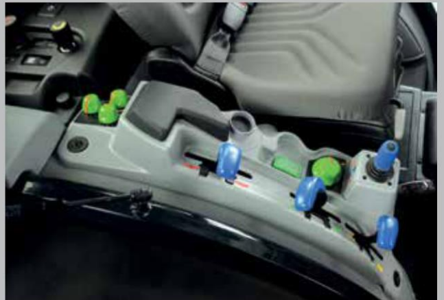
Интуитивно правление на задният навес и хидравличната система.
