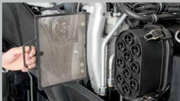
Двигателят е по-ефективен благодарение на нов и по-голям охладител, комбиниран с по-добър въздушен поток и въздушен филтър Powercore.
