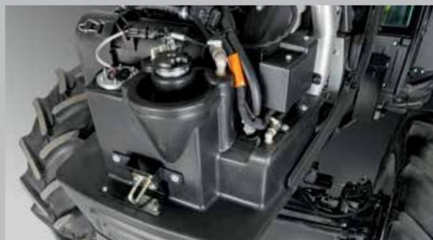
Резервоарът за гориво, интегриран в предната ос, може да се зарежда със затворен капак, докато вторичният резервоар е разположен под шасито.
