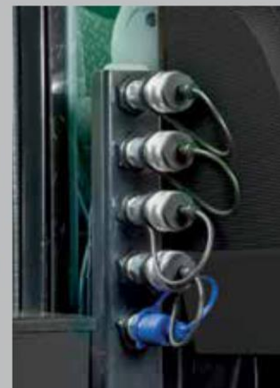
До шест хидреавлични клапана в задна и средна зона на навесване.
