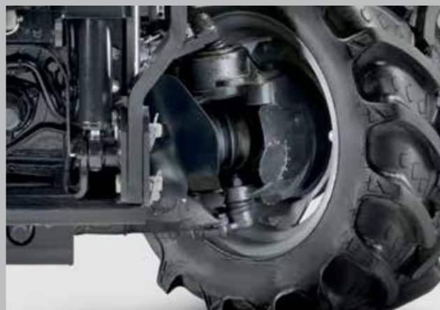
Спирачна система на 4-те колела. Отделни спирачки за предния мост. Сигурност във всяка ситуация.
