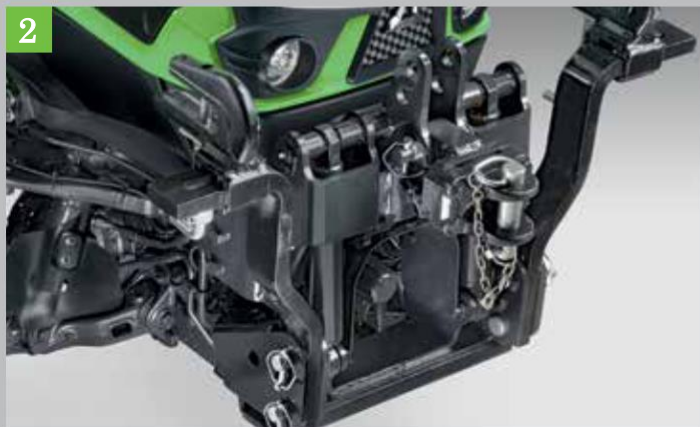
Преден навес с преден BOM за ефективна работа с предно-навесни инвентари.
