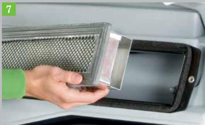
Въздушният филтър в кабината предотвратява навлизането на прах и други химикали във вътрешността на трактора. Чист въздух в купето, през цялото време..
