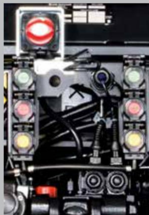
До шест хидреавлични клапана в задна и средна зона на навесване.
