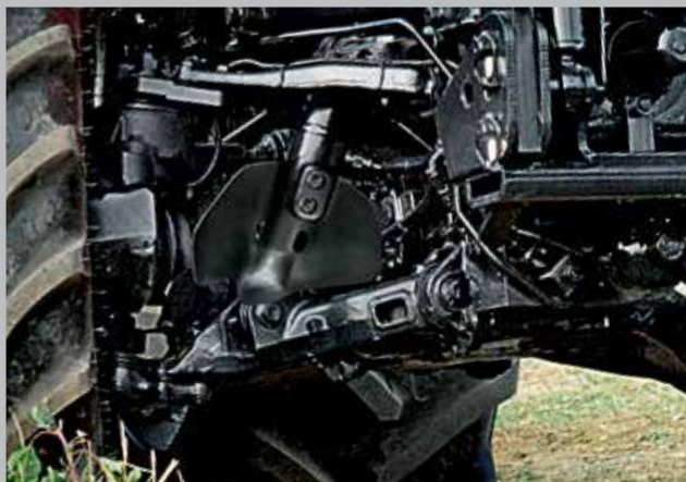
Двойно независимо окачване на предния мост.
