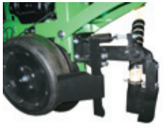
Vomerino spargizalle terreni con pietre Floating front clod pusher for stony soils Chasse motte flottant pour terrain avec des cailloux Surcador desterronador flotante para terrenos con piedras
