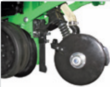
Disco doppio aprisolco concime Double opener disc manure Double disque ouverture fertiliseur Doble disco abrisurco fertilizante
